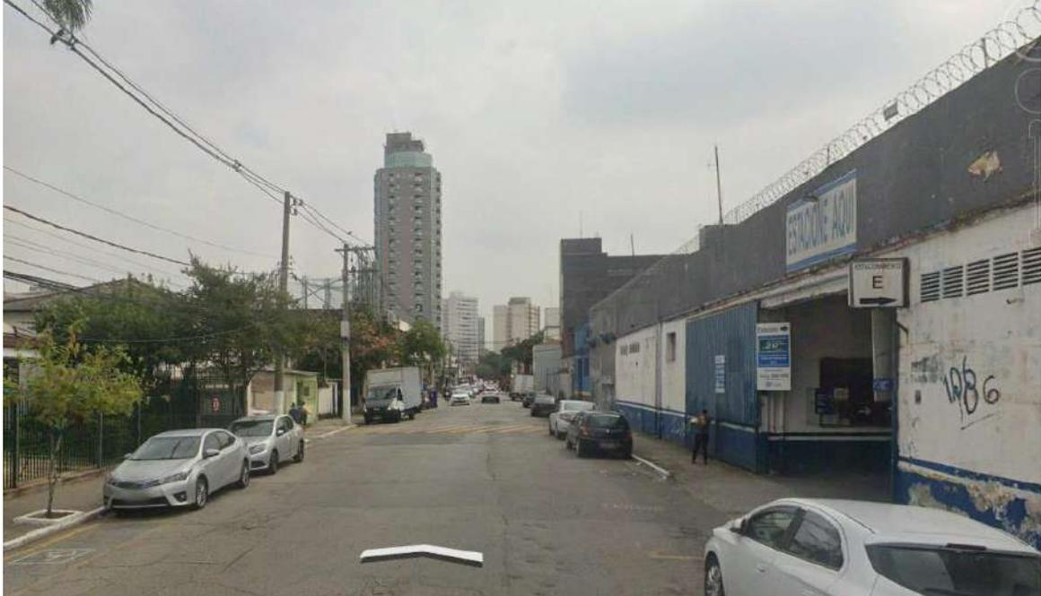
Figura 169 - Av. Casper Líbero, exemplo de passeio com piso irregular e sem piso tátil.
